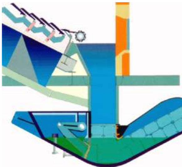
Rysunek 13: Przykładowa konstrukcja układu odżużlania.
