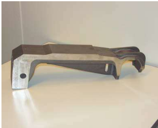
Rysunek 9: Pojedyncza rusztowina - ruszt chłodzony powietrzem.
