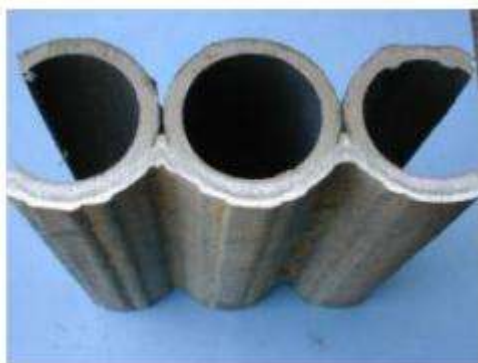
Rysunek 16: Przekrój ścian membranowych poddanych napawaniu.
