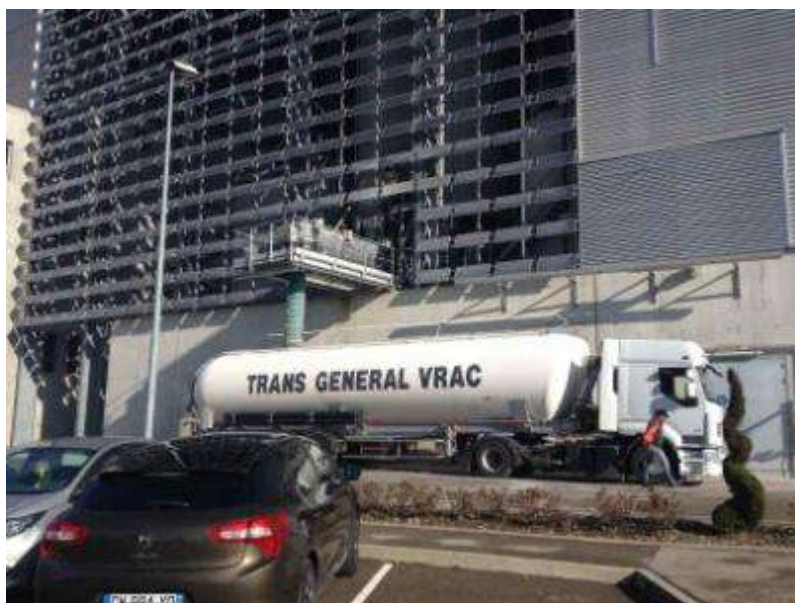
Rysunek 17: Załadunek pozostałości z oczyszczania spalin do cysterny.
