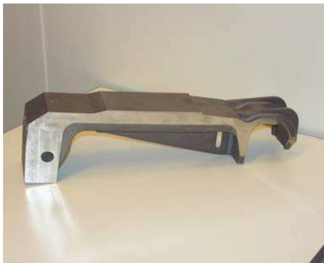
Rysunek 9: Pojedyncza rusztowina - ruszt chłodzony powietrzem.
